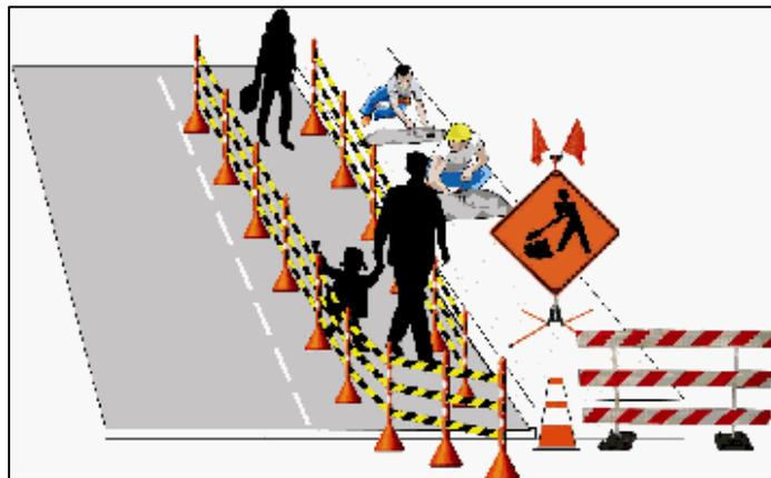
Cuando se adelanten labores de excavación en el frente de obra se debe aislar totalmente el área excavada (delimitar el área con cinta) y fijar avisos preventivos e informativos que indiquen la labor que se está
